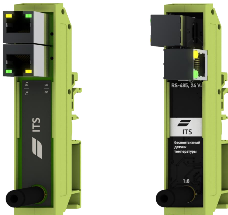
Рисунок 1.1. Внешний вид бесконтактного датчика температуры (слева – ITS1, справа – ITS2)
