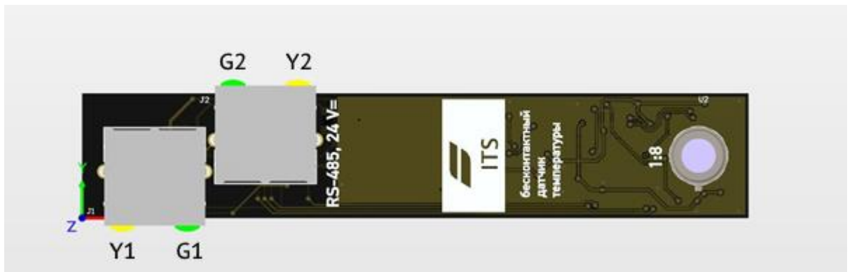
Рисунок 6.1. Расположение светодиодов на датчике
